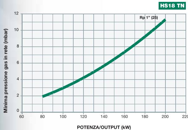
**Attenzione:** in ascissa è riportato il valore della potenza gas, in ordinata il corrispondente valore di pressione in rete al netto della pressione in camera di combustione. Per conoscere la pressione minima in ingresso rampa, necessaria per ottenere la portata gas richiesta, bisogna sommare la pressione in camera di combustione al valore letto in ordinata.
